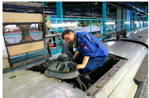
ICE エアコンを修理するエンジニア。(写真: www.ftd.de)
